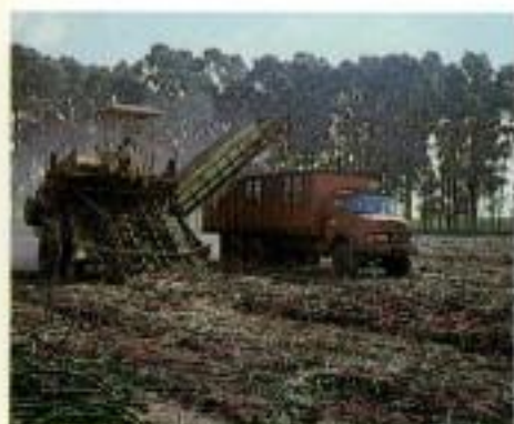
Figura 23. Carregadora convencional com "kit" de rastelo recolhedor, que fornece matéria-prima de melhor qualidade, porém faz cair a capacidade operacional da máquina. (Cortesia E. ARTIOLI).
