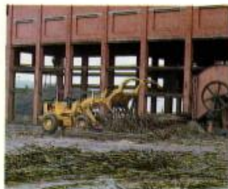
Figura 39. Abastecimento da mesa de recepção rebaixada com matéria-prima proveniente do pátio de es toque regulador, por meio de tra tor com garra frontal. (MIALHE, foto).
