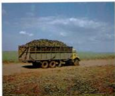
Figura 30. Caminhão de tração dupla (trucado) e carroceria fechada para transporte de cana picada, colhida por combinadas. (RIPOLI, foto).
