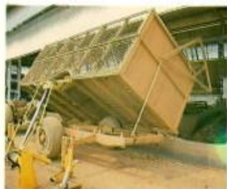
Figura 41. Sub-sistema de recepção: descarregamento de êmbolos hidráulicos atuando em carretas para ca na picada. (RIPOLI, foto).
