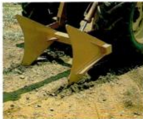
Figura 18. Tipo de rastelo de carregadoras montadas em tratores: convencional. (Cortesia SANTAL Equip. S/A).
