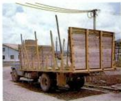
Figura 29. Caminhão com tração simples (toco) e fueiros de madeira para transporte de cana inteira. (MIALHE, foto).
