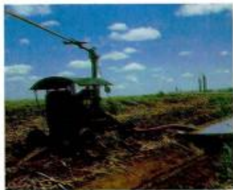
Figura 11. Fertirrigação por aspersão com canhão hidráulico.
