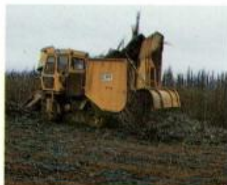
Figura 11. Cortadora-amontoadora auto-propelida ARTIOLI com capacidade operacional por volta de 20-30 t/h. (Cortesia E. Artoli Ltda.).
