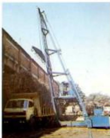
Figura 38. Sub-sistema de recepção: descarregamento de cana inteira através de guincho hidráulico tipo "HILO" (NOTOCANA, foto).
