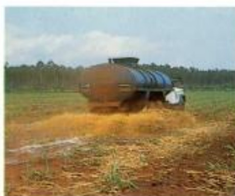
Figura 7. Aplicação de vinhaça por caminhão-tanque: descarga por gravidade com 6 saídas.
