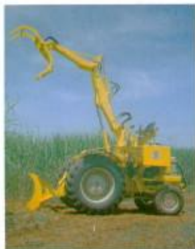
Figura 16. Carregadora convencional montada sobre trator. (Cortesia MOTOCENA S/A).
