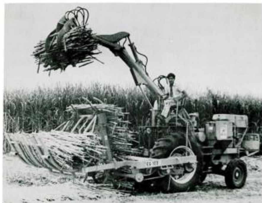
Figura 22. Carregadora contínua ("continuous loader") desenvolvida pela COPERSUCAR. (BRUNHECK, foto).
