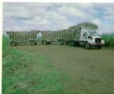
Figura 31. Transporte denominado TREMINHÃO, com capacidade para 45 t, com carroceria de fueiros metálicos para cana inteira. (Cortesia da Rev. Alcool e Açúcar).
