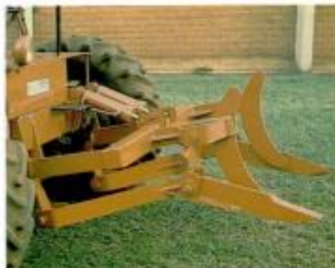
Figura 19. Tipo de rastelo articulado de carregadoras montadas em tra tores. (Cortesia SANTAL Equip. S/A).
