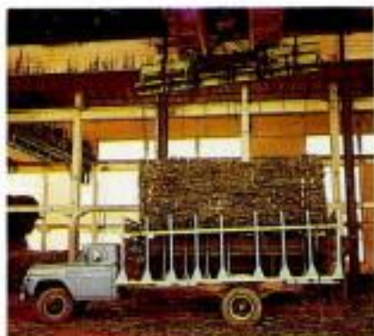
Figura 37. Sub-sistema de recepção: descarregamento através de ponte rolante de matéria prima cortada, enfeixada e carregada manualmente. (MIALHE, foto).
