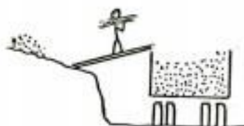
Figura 14. Carregamento manual em zona de fortes declives.
